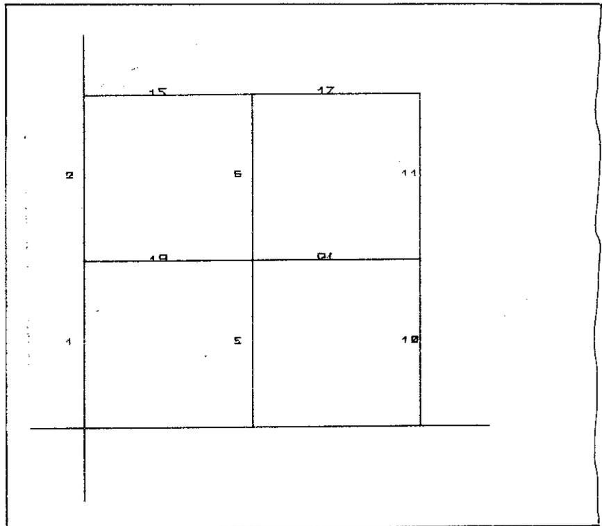
Fig; 3-15 Numerazione dei nodi e delle aste (1° sezione)
