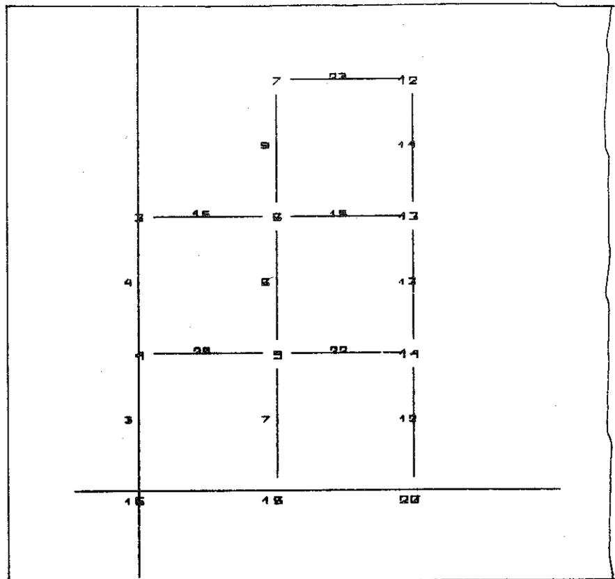
Fig. 3-27 Numerazione dei nodi e delle aste (2° sezione)
