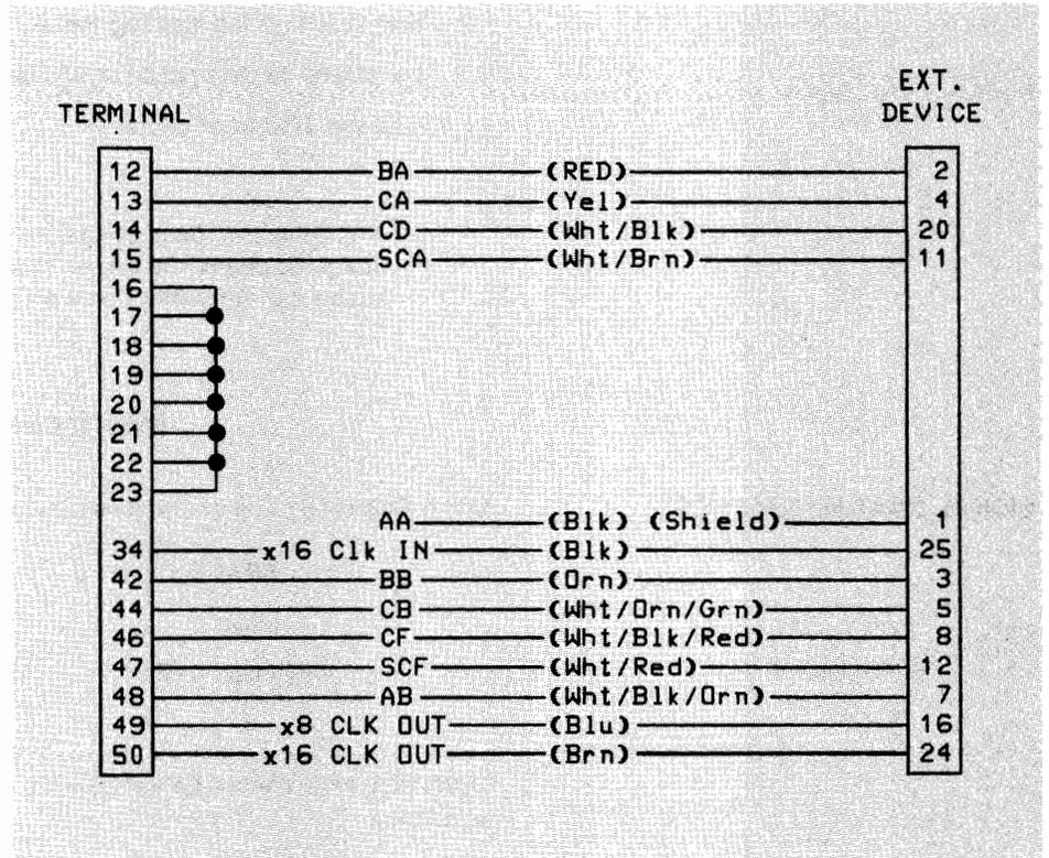
Figure 2-7. 13222C (RS232C) Cable Wiring
