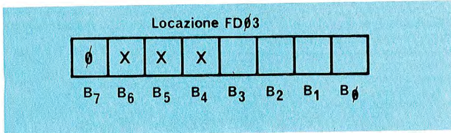
Fig. 54 - Uso del registro del modo di funzionamento per usare la porta C indirizzando i suoi bit uno per uno.
